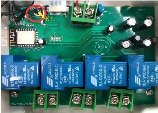
Comme sur la photo ci-dessus, en appuyant sur le bouton K1, vous pouvez basculer entre 2 modes : contrôle marche/arrêt, contrôle du boîtier avec la télécommande. Le mode activé par défaut est le mode Marche/Arrêt manuel.
